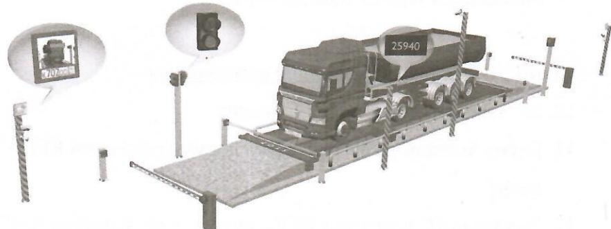
8. При достижении определенного значения веса (по умолчанию равному 500 кг.), в процессе заезда ТС на весовую платформу, загорается красный сигнал светофора. Величина веса, при котором загорается красный сигнал светофора – параметр настраиваемый.
