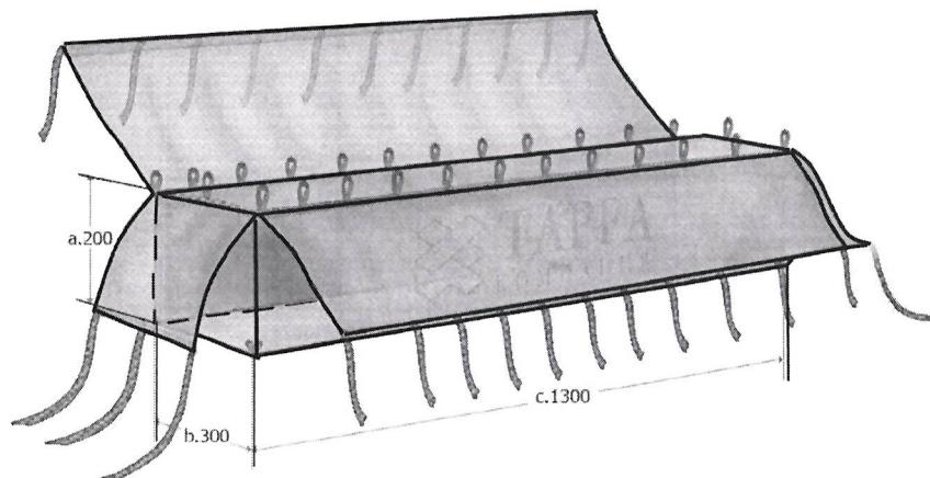
**Рис.1.Схема вкладыша вагонного**
